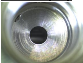
Loser Span am Bohrungsgrund
