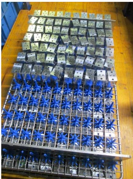
Bauteile dieser Klasse müssen für den Transport und die weitere Bearbeitung auf ein Waschgitter gesteckt werden. Schraubensenkung nach unten. Teile müssen frei von Graten und festsitzenden Spänen sein.
